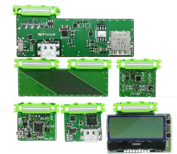
上から1段目：LTE-Mリーフ、2段目：Leaf×2リーフ、4-Sensorsリーフ、3段目：AVR MCUリーフ、USBリーフ、LCDリーフ
