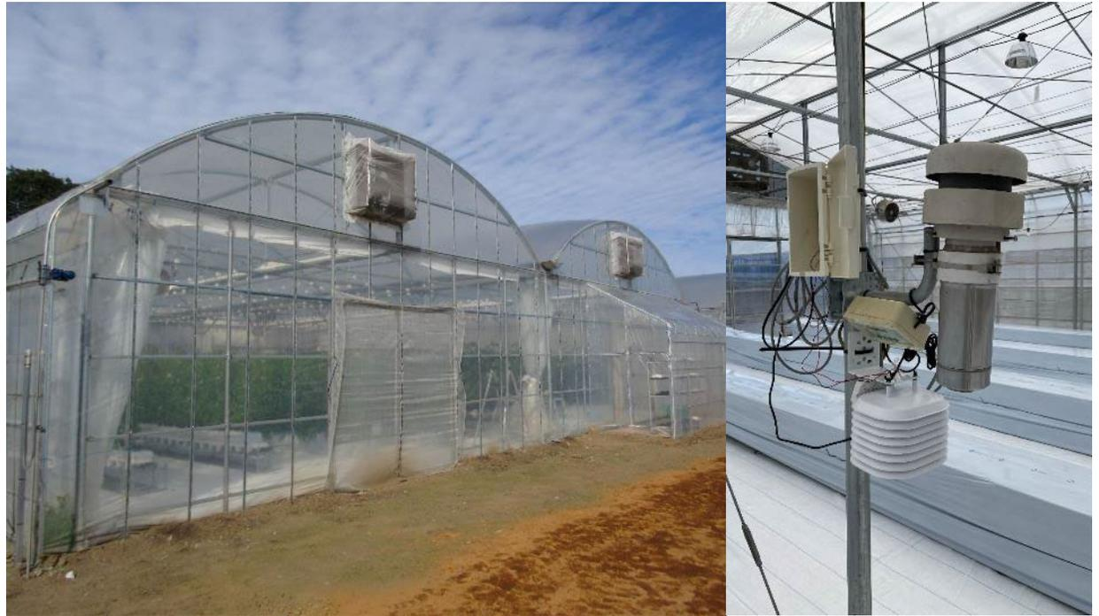
検証場所は「東京フューチャーアグリシステム」（農総研開発の小規模太陽光利用型植物工場）、既設の強制通風筒内には環境制御用の温湿度センサーがあるので後日検証可能
