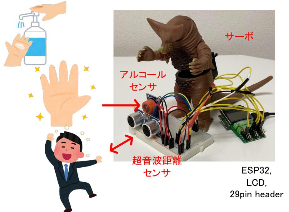
1. リーフォニーに接続している超音波距離センサにより、設定位置に手があることを検知
